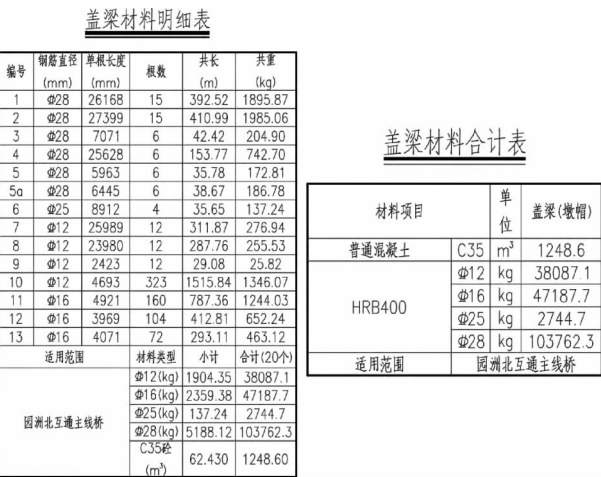
图 4 盖梁 CAD 工程数量明细表和合计表(分表)示意图
