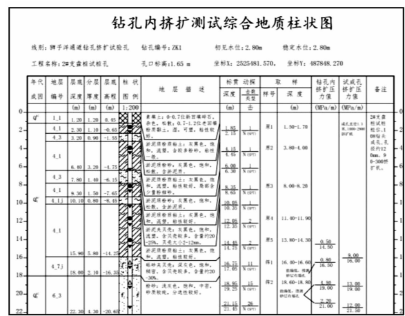
图 5 钻孔内挤扩测试综合地质柱状图
