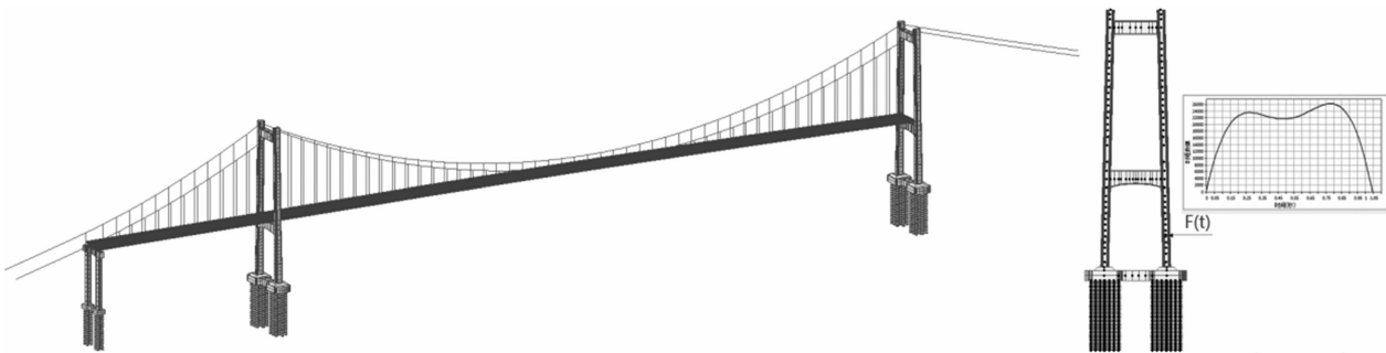
图 9 肇云大桥主桥有限元模型
